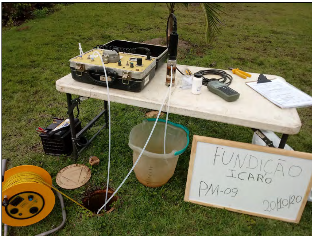
Foto 12. Amostragem através do método de baixa vazão no poço de monitoramento PM-09.
