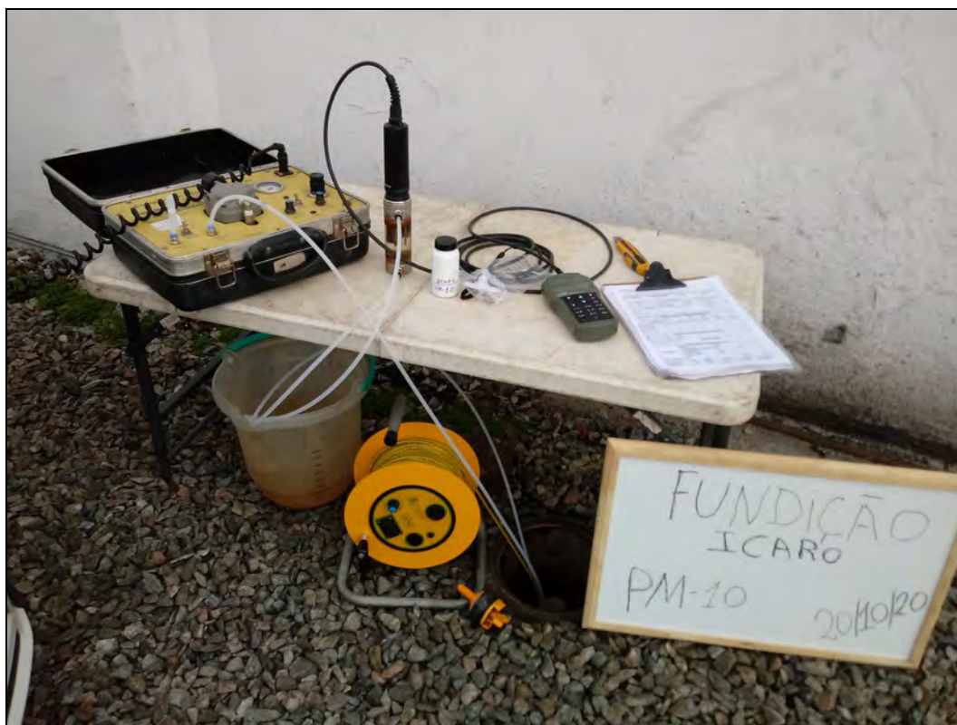
Foto 5. Amostragem através do método de baixa vazão no poço de monitoramento PM-10
