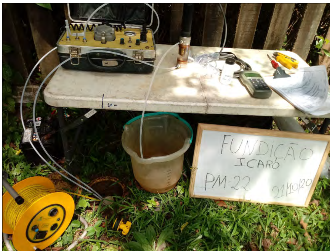
Foto 11. Amostragem através do método de baixa vazão no poço de monitoramento PM-22.
