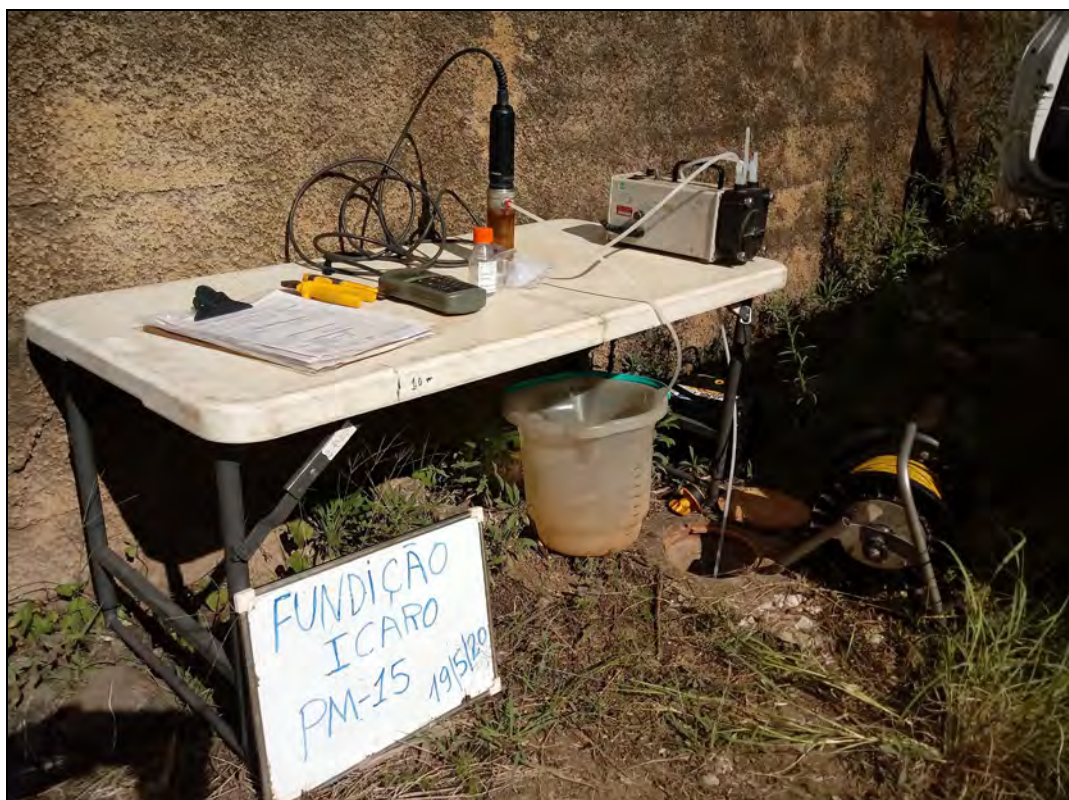
Foto 7. Amostragem através do método de baixa vazão no poço de monitoramento PM-15.
