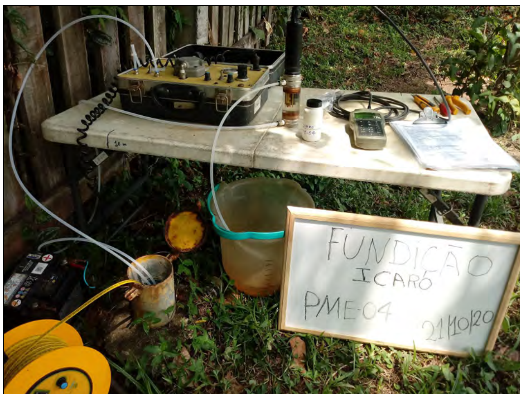
Foto 10. Amostragem através do método de baixa vazão no poço de monitoramento PME-04.
