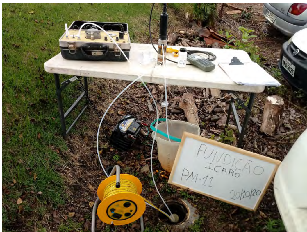
Foto 6. Amostragem através do método de baixa vazão no poço de monitoramento PM-11.
