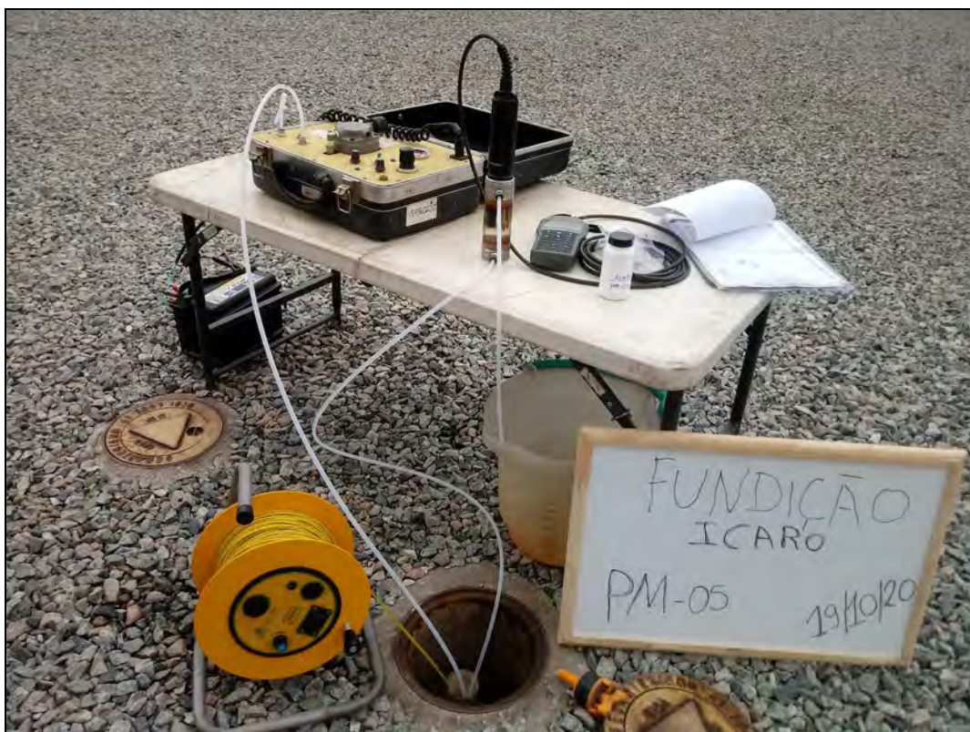
Foto 1. Amostragem através do método de baixa vazão no poço de monitoramento PM-05.
