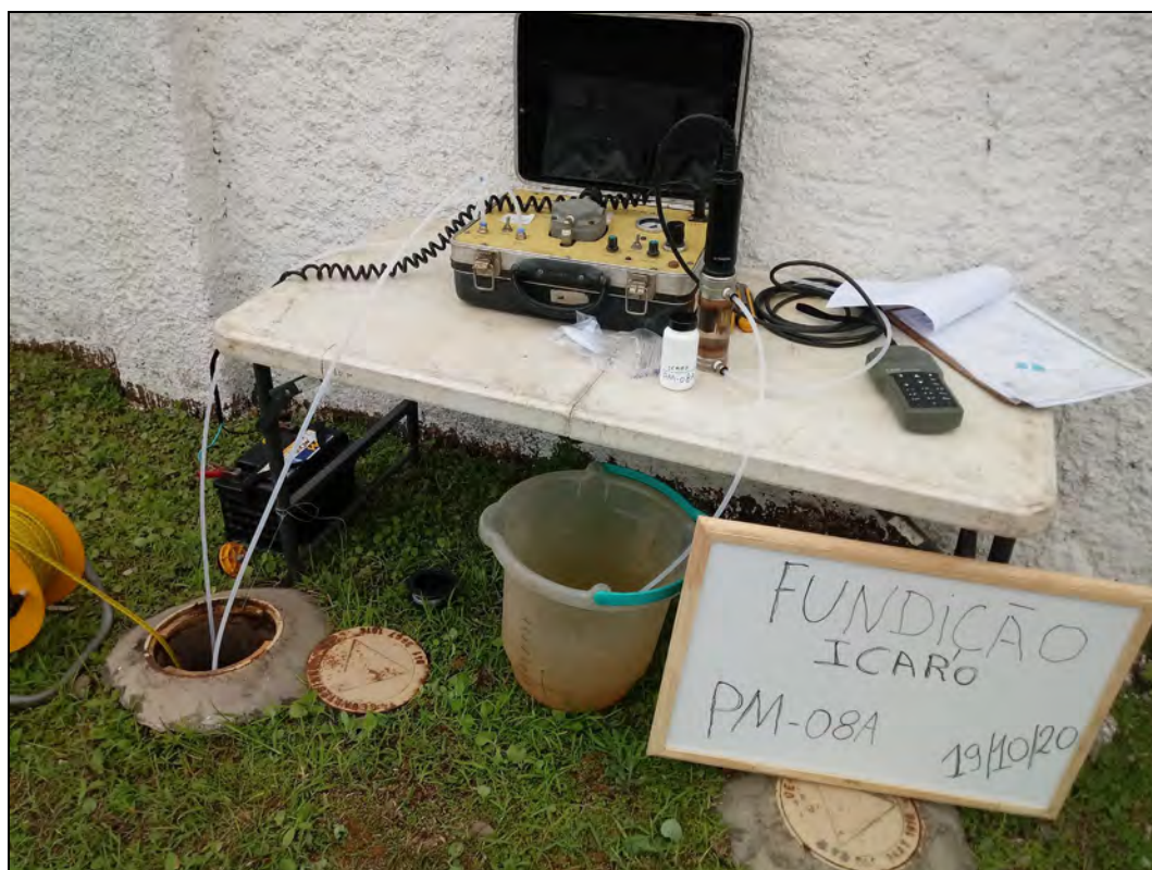
Foto 4. Amostragem através do método de baixa vazão no poço de monitoramento PM-08A.
