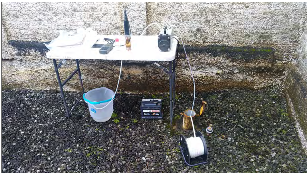
Foto 9. Amostragem através do método de baixa vazão no poço de monitoramento PME-01.
