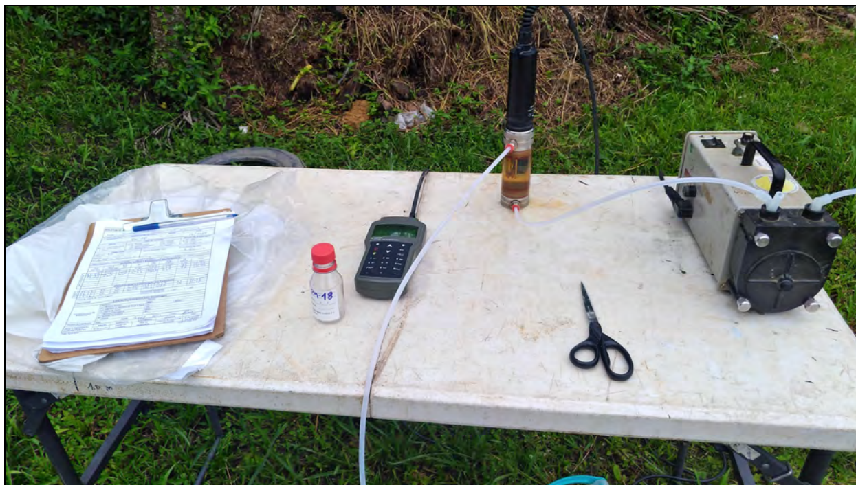
Foto 7. Amostragem através do método de baixa vazão no poço de monitoramento PM-18.
