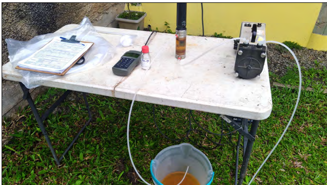
Foto 8. Amostragem através do método de baixa vazão no poço de monitoramento PM-19.
