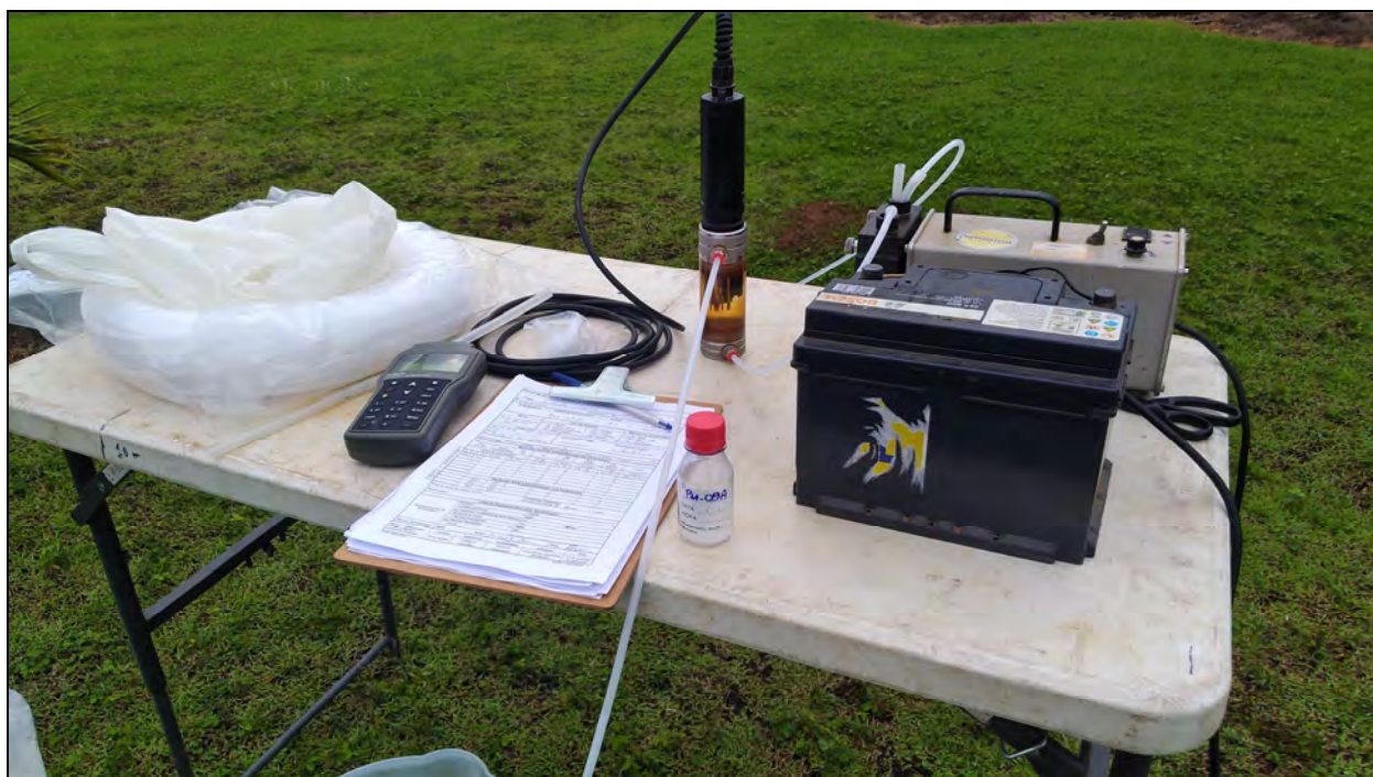
Foto 4. Amostragem através do método de baixa vazão no poço de monitoramento PM-09A.
