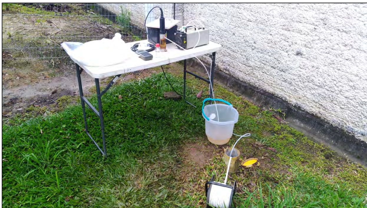
Foto 10. Amostragem através do método de baixa vazão no poço de monitoramento PME-03.
