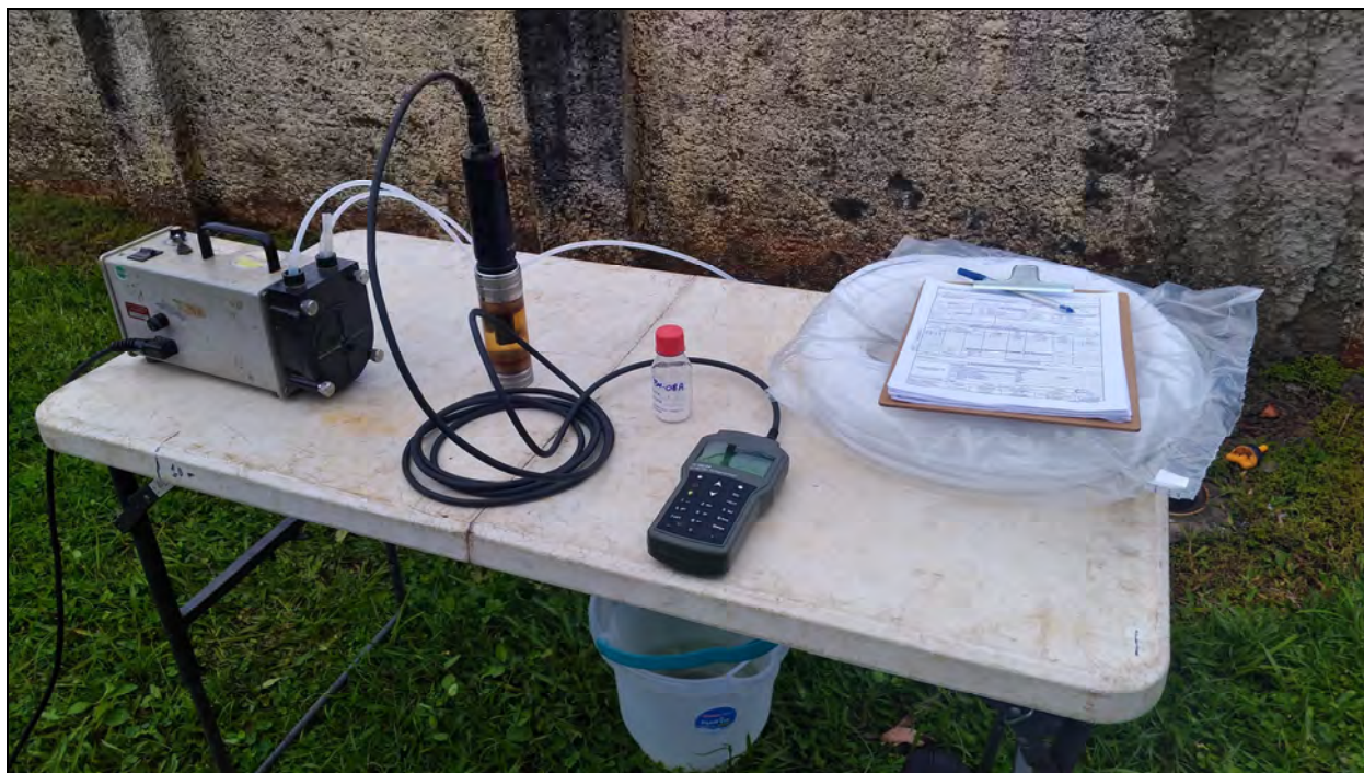
Foto 3. Amostragem através do método de baixa vazão no poço de monitoramento PM-08A.
