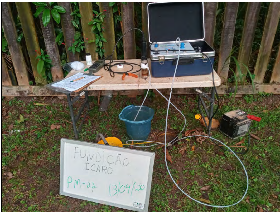
Foto 19. Amostragem através do método de baixa vazão no poço de monitoramento PM-22.
