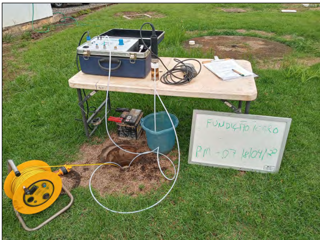
Foto 7. Amostragem através do método de baixa vazão no poço de monitoramento PM-07.
