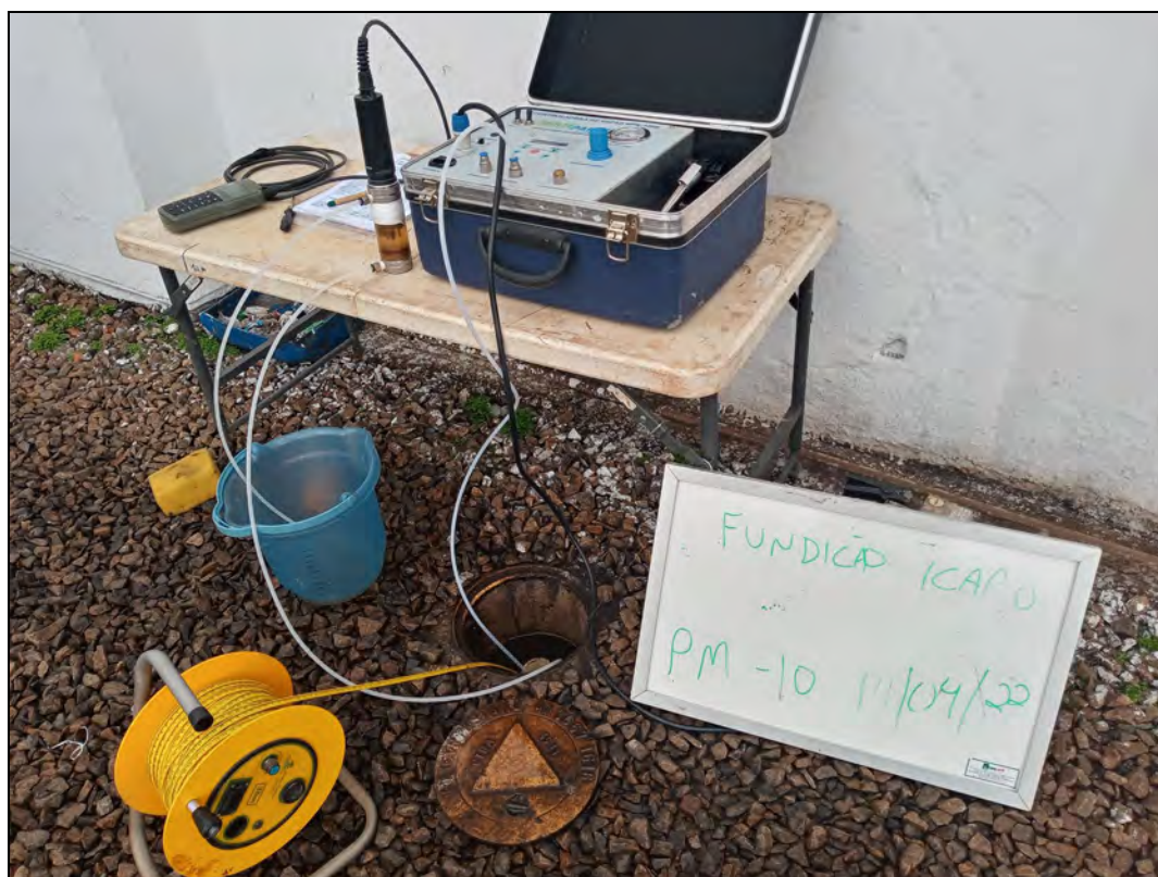
Foto 12. Amostragem através do método de baixa vazão no poço de monitoramento PM-10.
