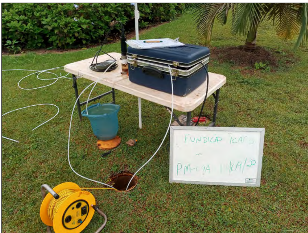
Foto 11. Amostragem através do método de baixa vazão no poço de monitoramento PM-09A.
