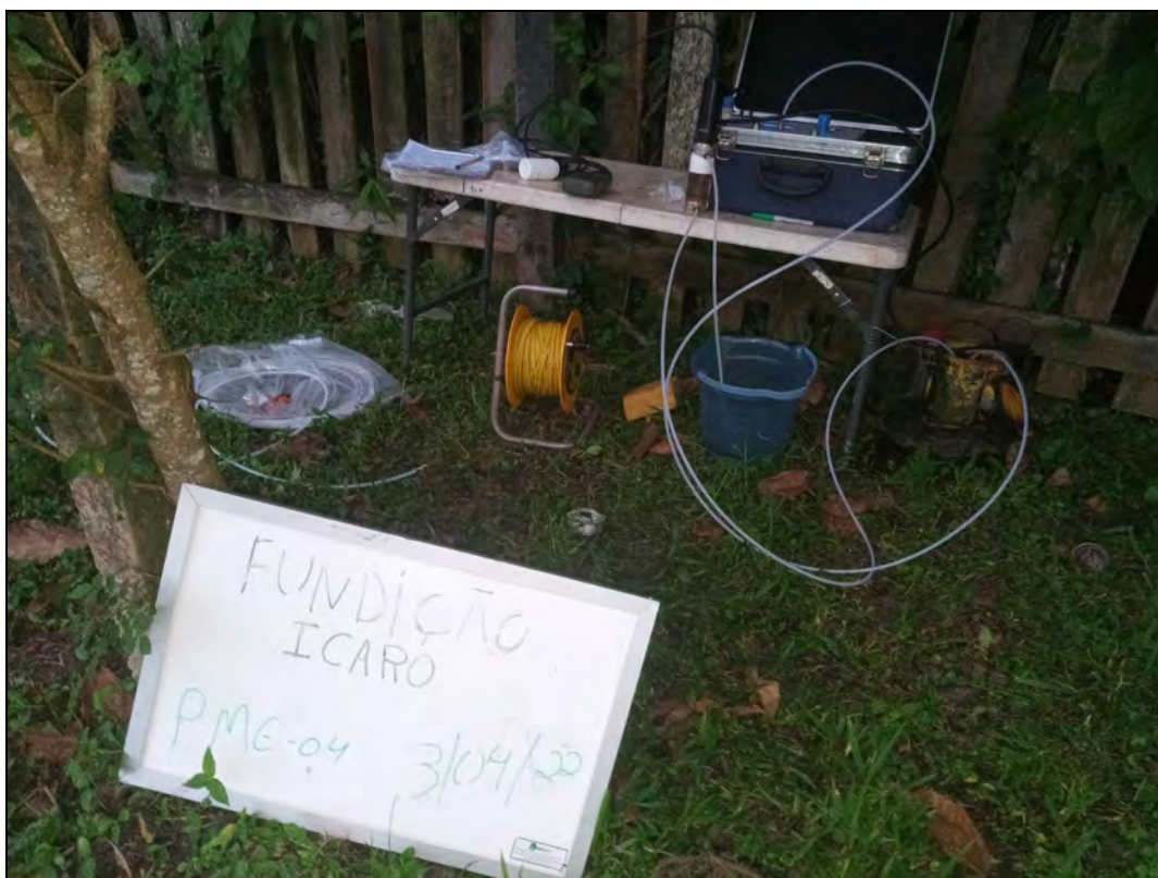
Foto 3. Amostragem através do método de baixa vazão no poço de monitoramento PME-04.
