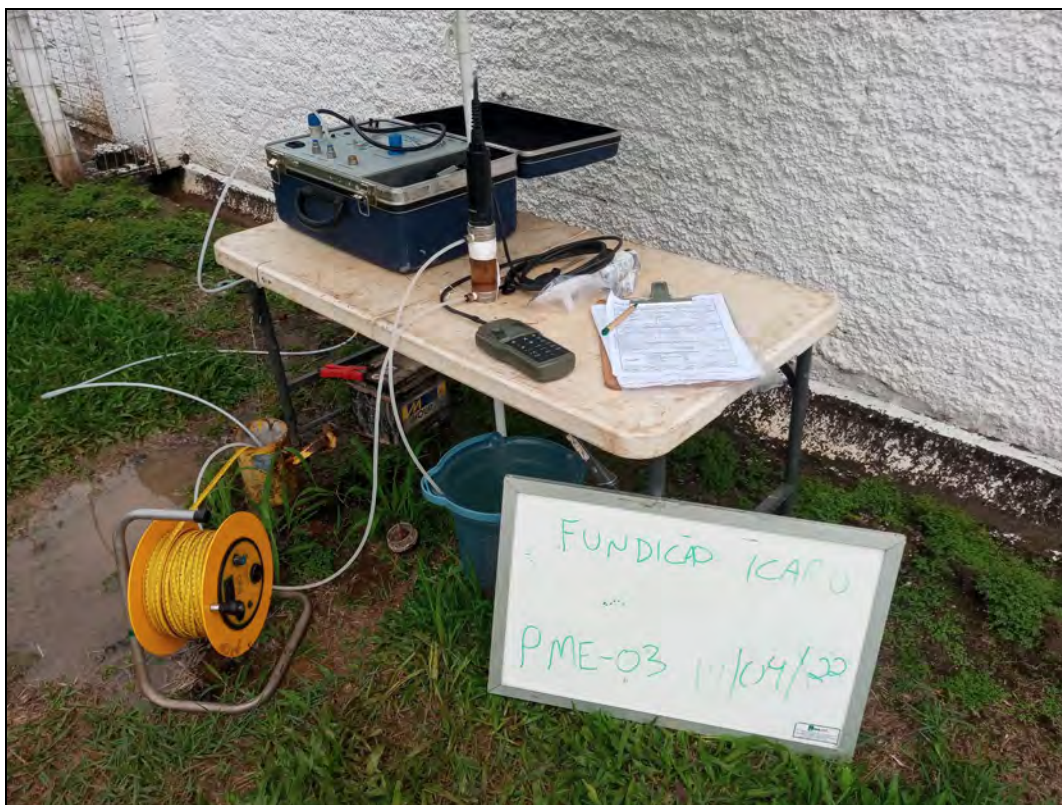
Foto 2. Amostragem através do método de baixa vazão no poço de monitoramento PME-03.
