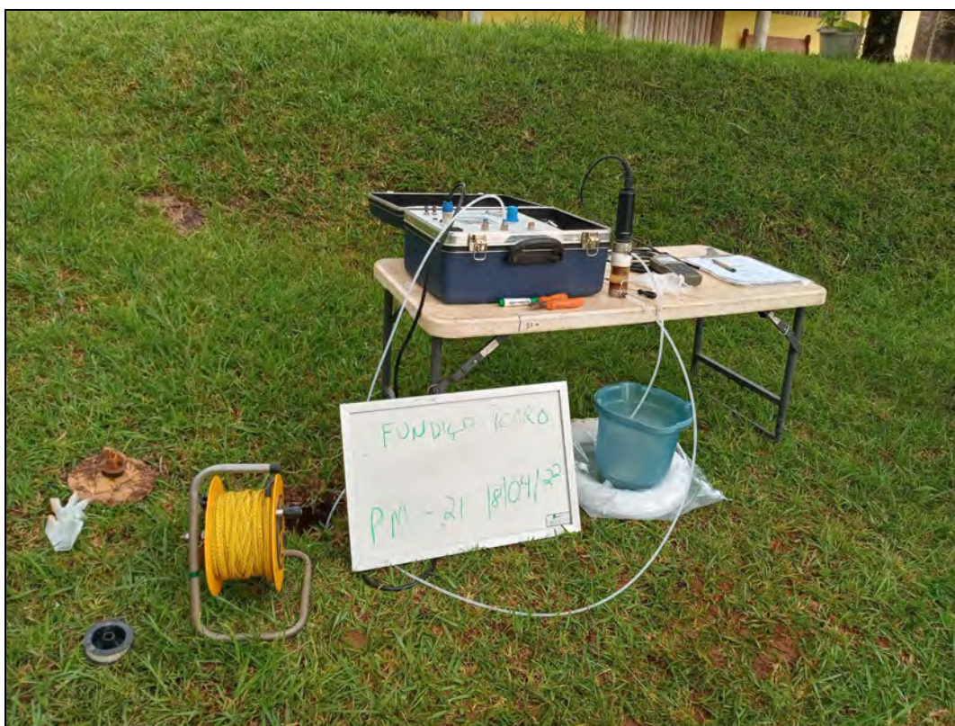
Foto 18. Amostragem através do método de baixa vazão no poço de monitoramento PM-21.
