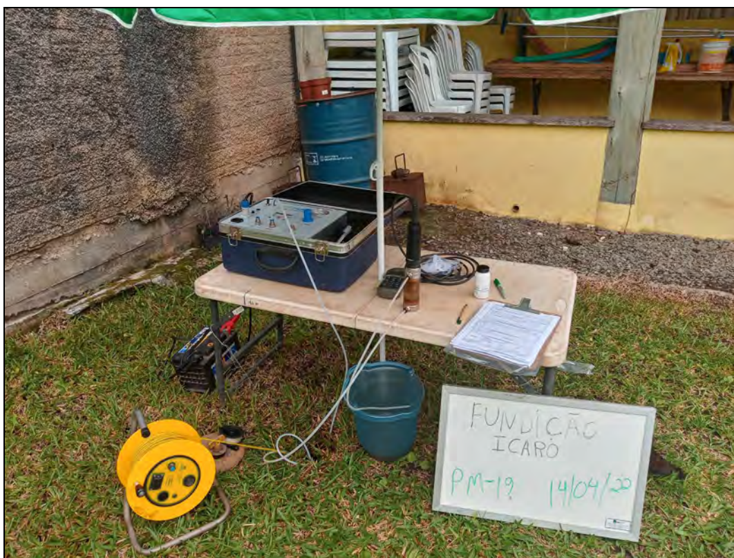
Foto 16. Amostragem através do método de baixa vazão no poço de monitoramento PM-19.
