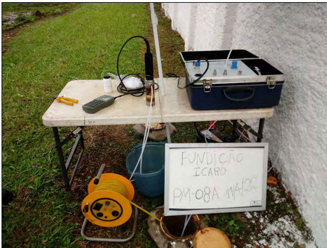
Foto 9. Amostragem através do método de baixa vazão no poço de monitoramento PM-08A.
