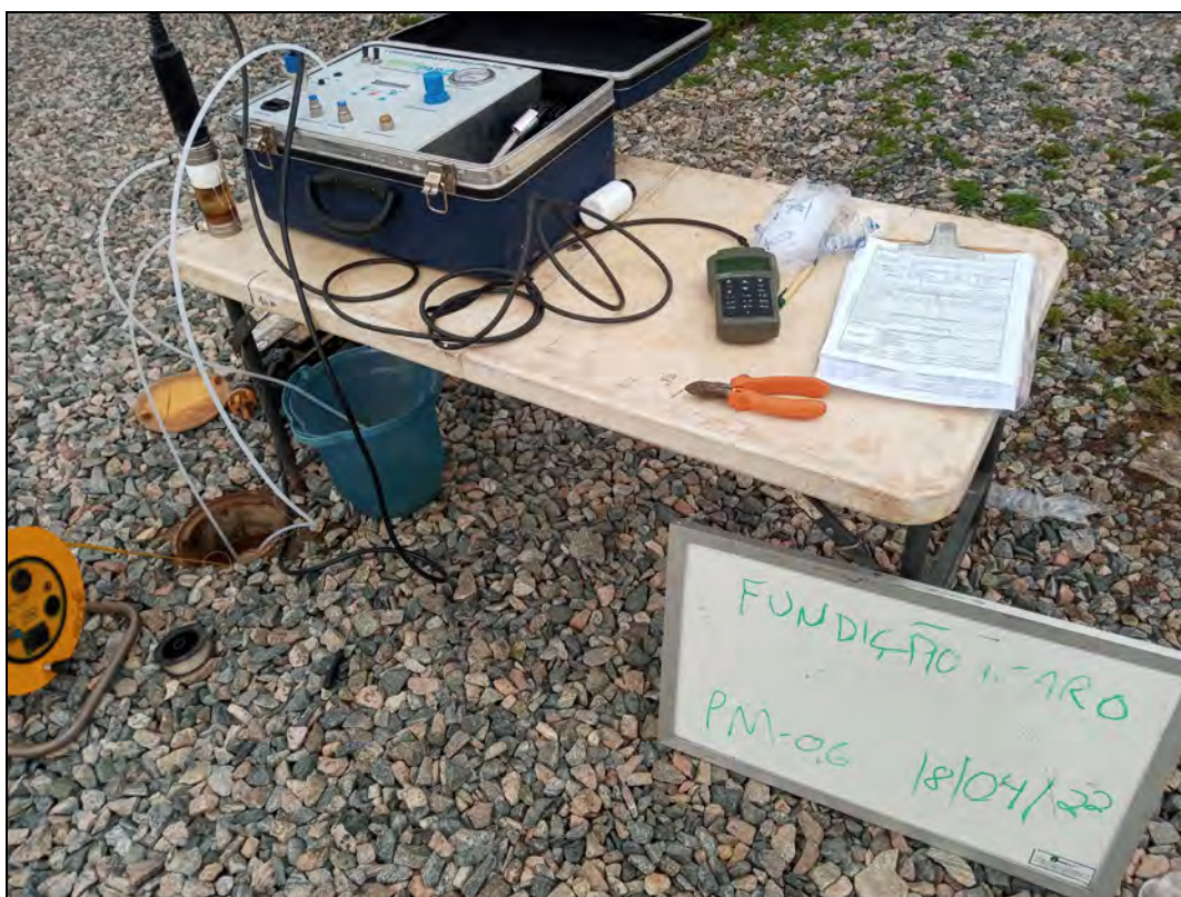
Foto 6. Amostragem através do método de baixa vazão no poço de monitoramento PM-06.
