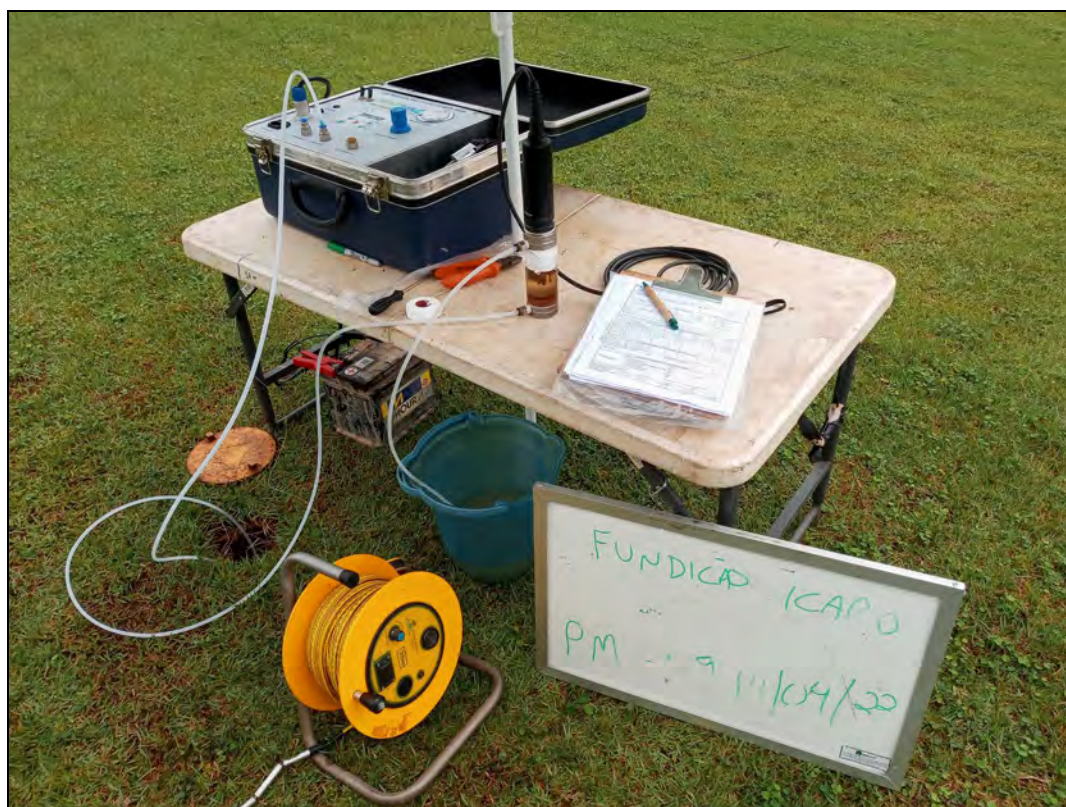
Foto 10. Amostragem através do método de baixa vazão no poço de monitoramento PM-09.
