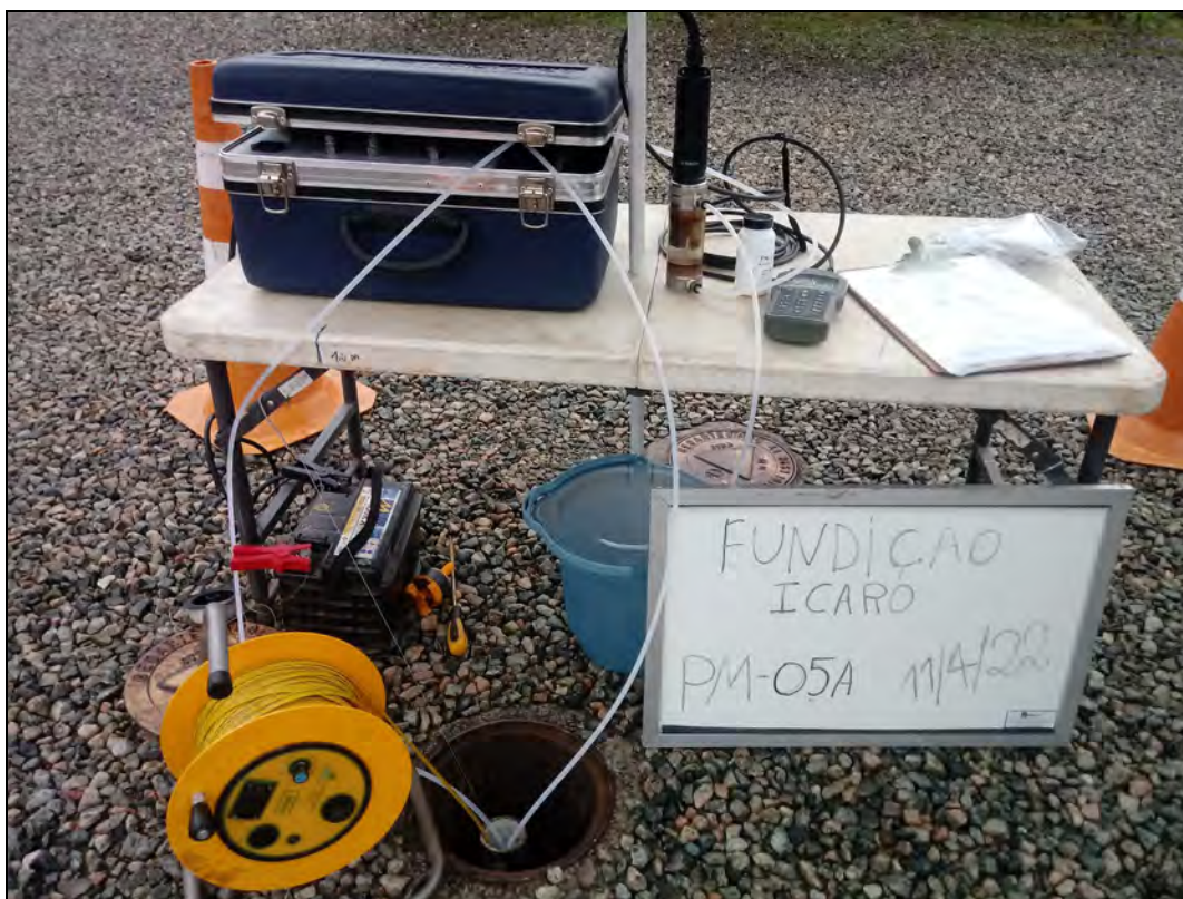
Foto 5. Amostragem através do método de baixa vazão no poço de monitoramento PM-05A.
