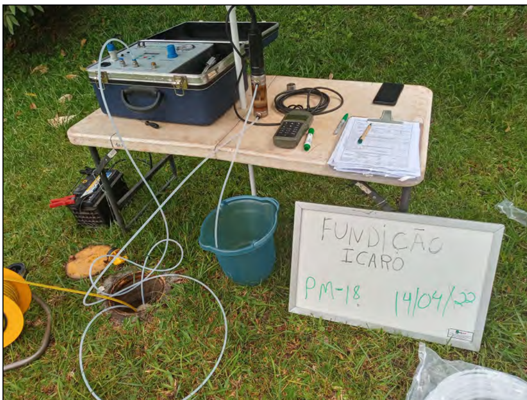
Foto 15. Amostragem através do método de baixa vazão no poço de monitoramento PM-18.
