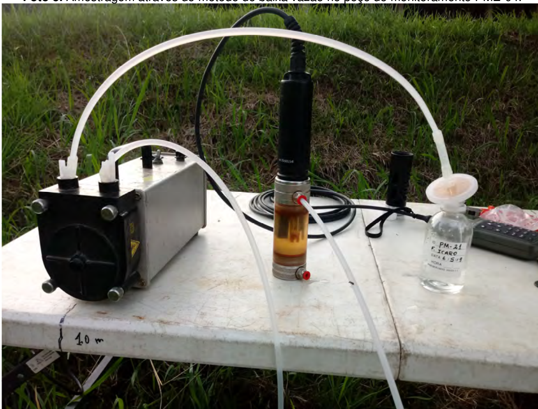
Foto 6. Amostragem através do método de baixa vazão no poço de monitoramento PM-21.
