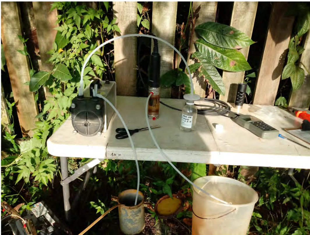
Foto 5. Amostragem através do método de baixa vazão no poço de monitoramento PME-04.
