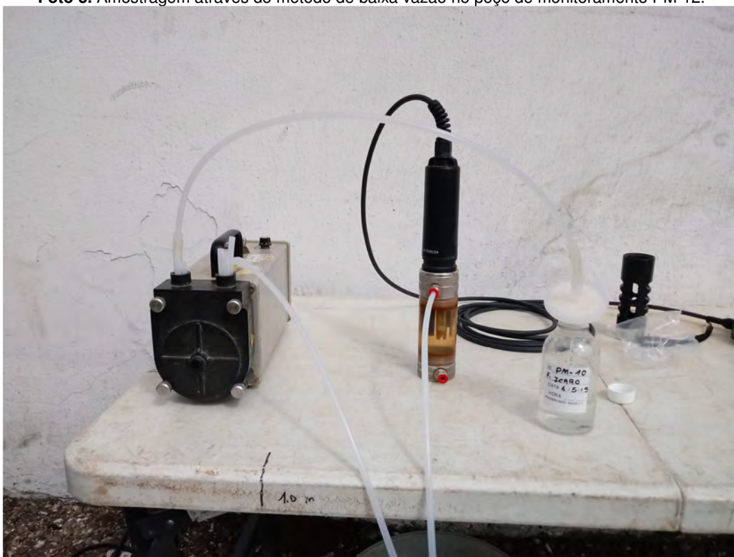
Foto 4. Amostragem através do método de baixa vazão no poço de monitoramento PM-10.
