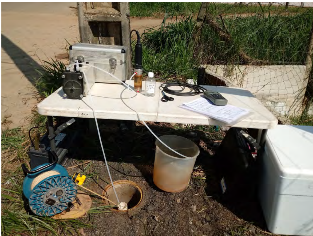
Foto 3. Amostragem através do método de baixa vazão no poço de monitoramento PM-12.
