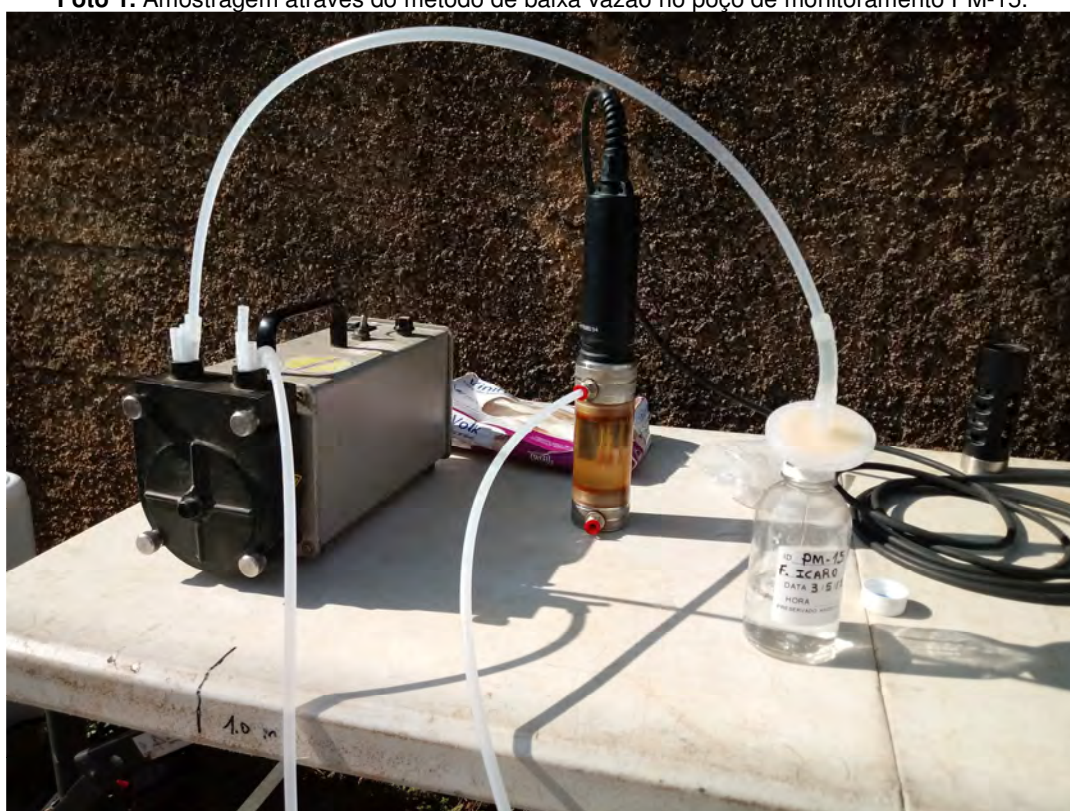
Foto 2. Amostragem através do método de baixa vazão no poço de monitoramento PM-15.
