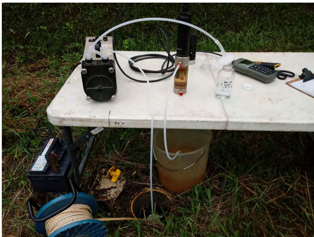
Foto 7. Amostragem através do método de baixa vazão no poço de monitoramento PM-18.
