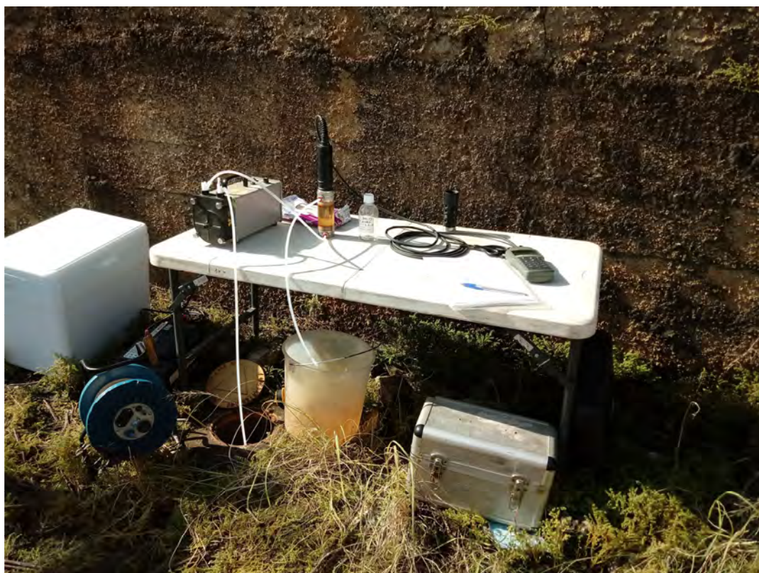
Foto 1. Amostragem através do método de baixa vazão no poço de monitoramento PM-15.
