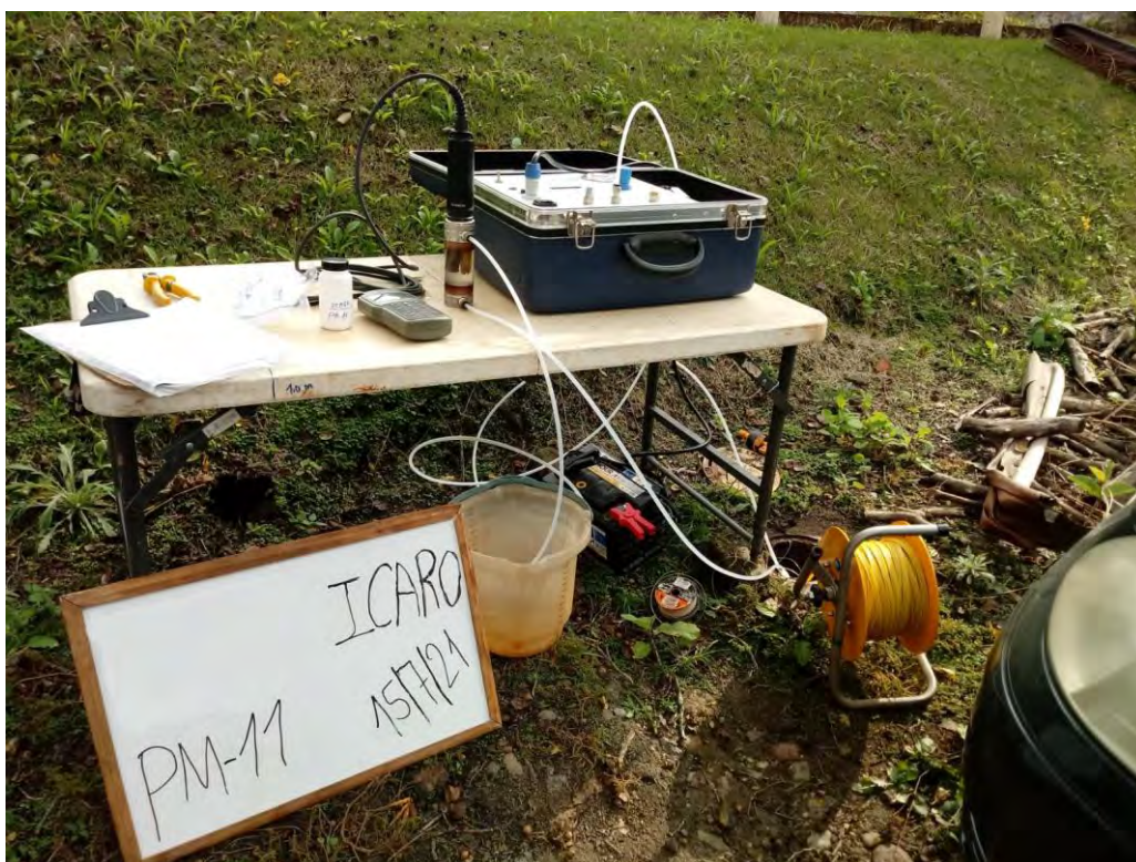
Foto 15. Amostragem através do método de baixa vazão no poço de monitoramento PM-11.
