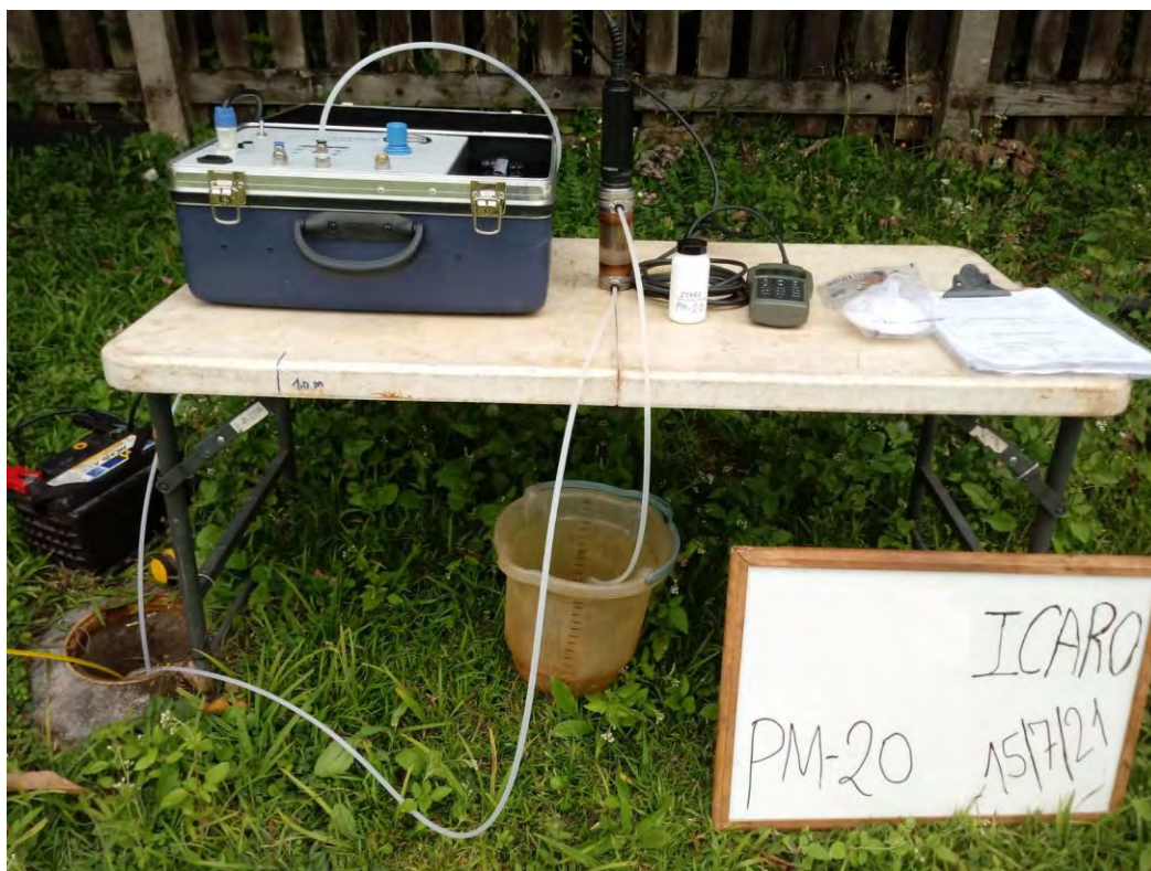
Foto 17. Amostragem através do método de baixa vazão no poço de monitoramento PM-20.
