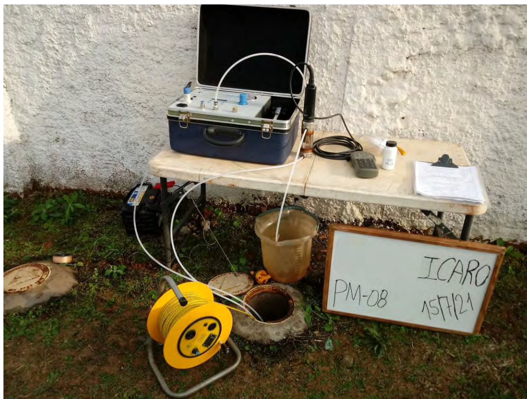
Foto 7. Amostragem através do método de baixa vazão no poço de monitoramento PM-08.
