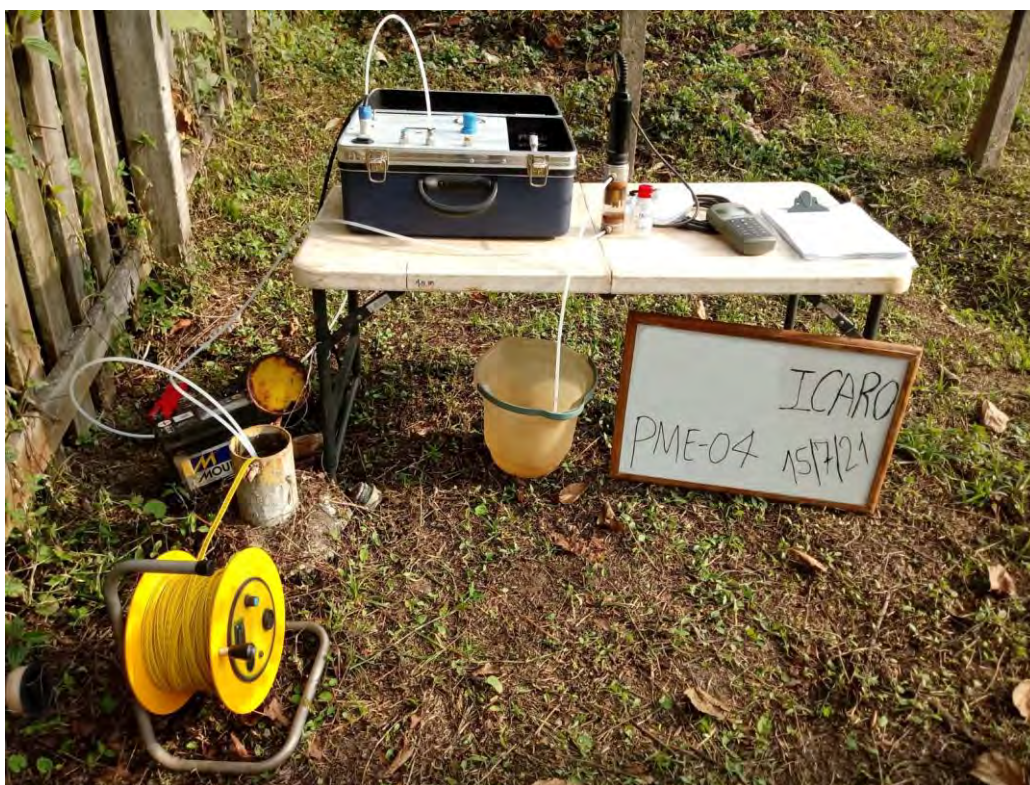
Foto 20. Amostragem através do método de baixa vazão no poço de monitoramento PME-04.
