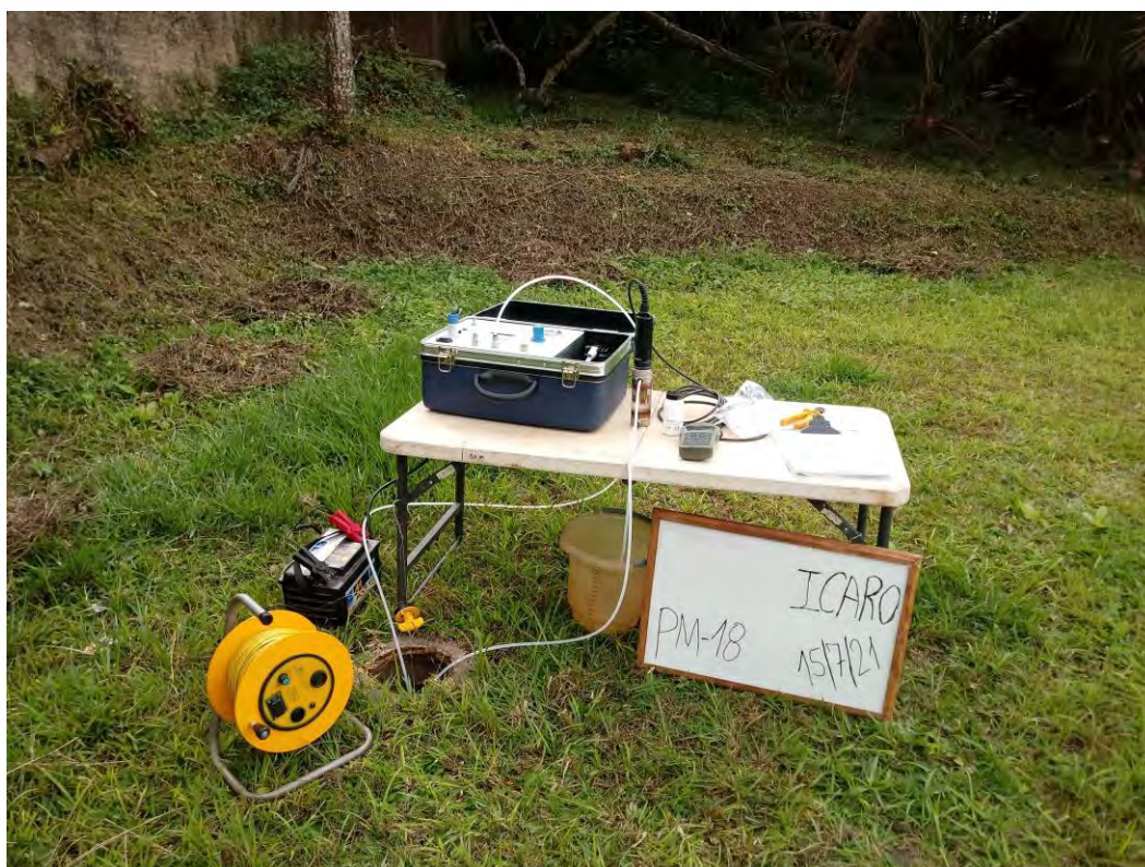
Foto 14. Amostragem através do método de baixa vazão no poço de monitoramento PM-18.
