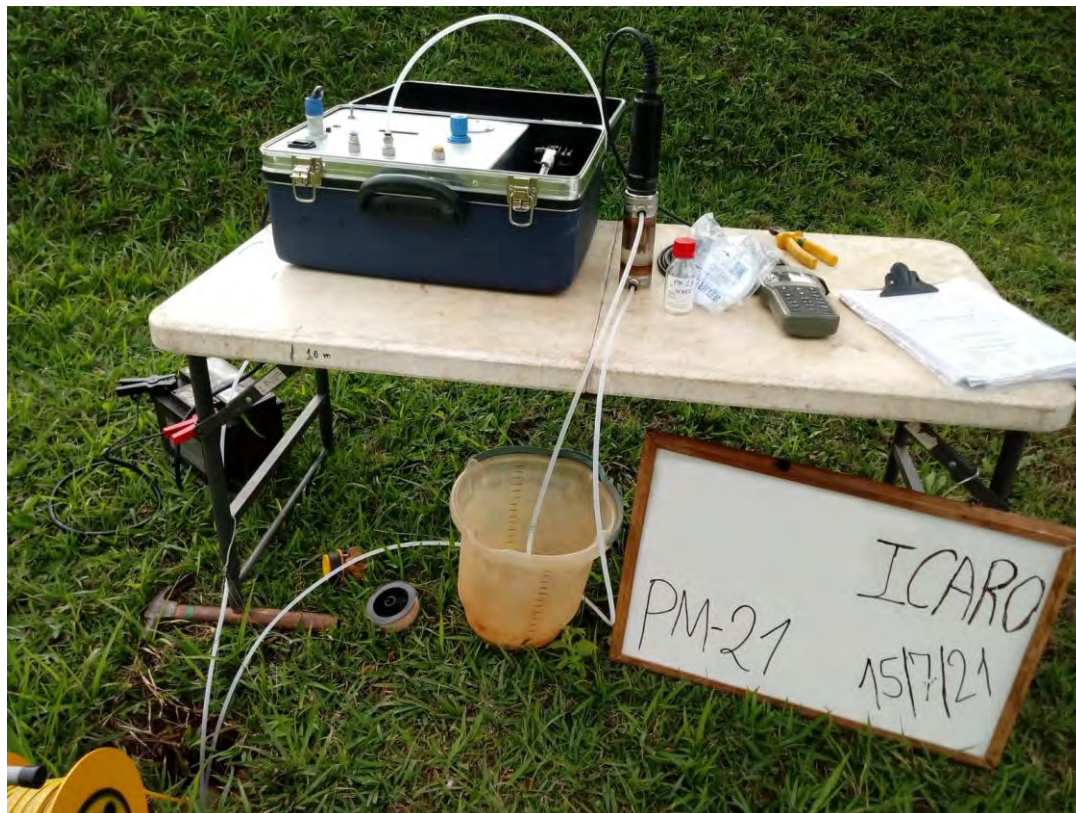
Foto 18. Amostragem através do método de baixa vazão no poço de monitoramento PM-21.
