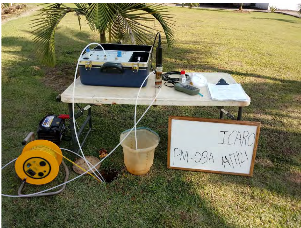
Foto 13. Amostragem através do método de baixa vazão no poço de monitoramento PM-09A.
