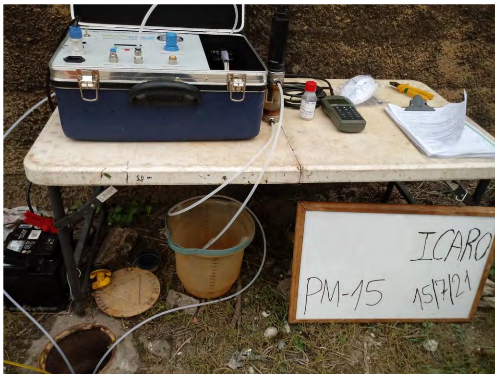
Foto 16. Amostragem através do método de baixa vazão no poço de monitoramento PM-15.
