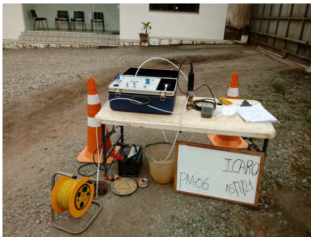
Foto 2. Amostragem através do método de baixa vazão no poço de monitoramento PM-06.
