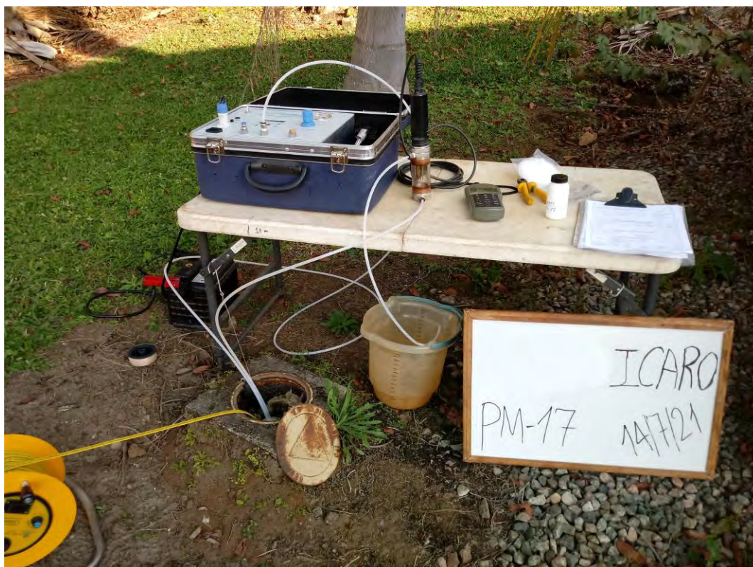
Foto 11. Amostragem através do método de baixa vazão no poço de monitoramento PM-17.
