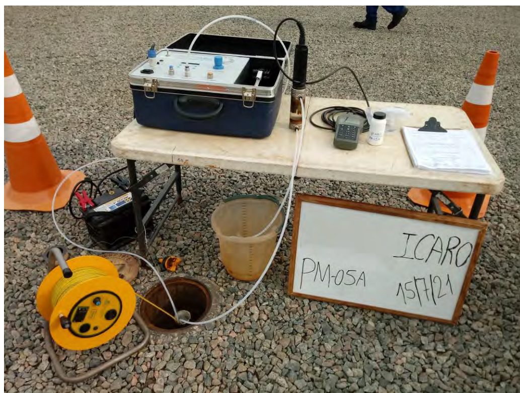
Foto 6. Amostragem através do método de baixa vazão no poço de monitoramento PM-05A.
