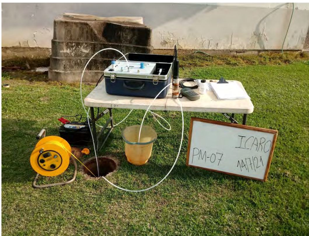
Foto 3. Amostragem através do método de baixa vazão no poço de monitoramento PM-07.
