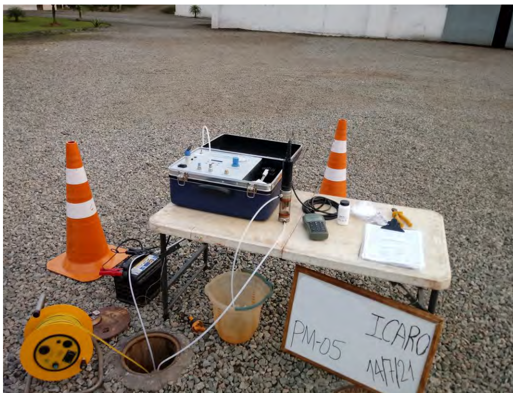
Foto 1. Amostragem através do método de baixa vazão no poço de monitoramento PM-05.
