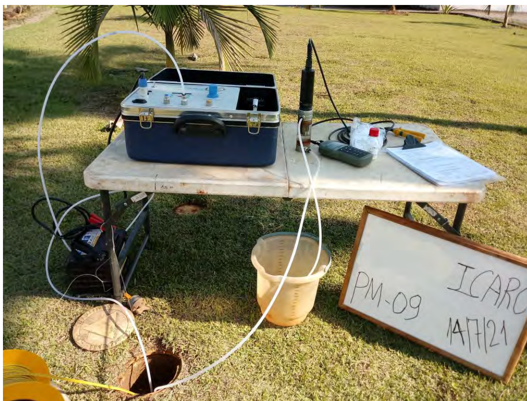
Foto 12. Amostragem através do método de baixa vazão no poço de monitoramento PM-09.
