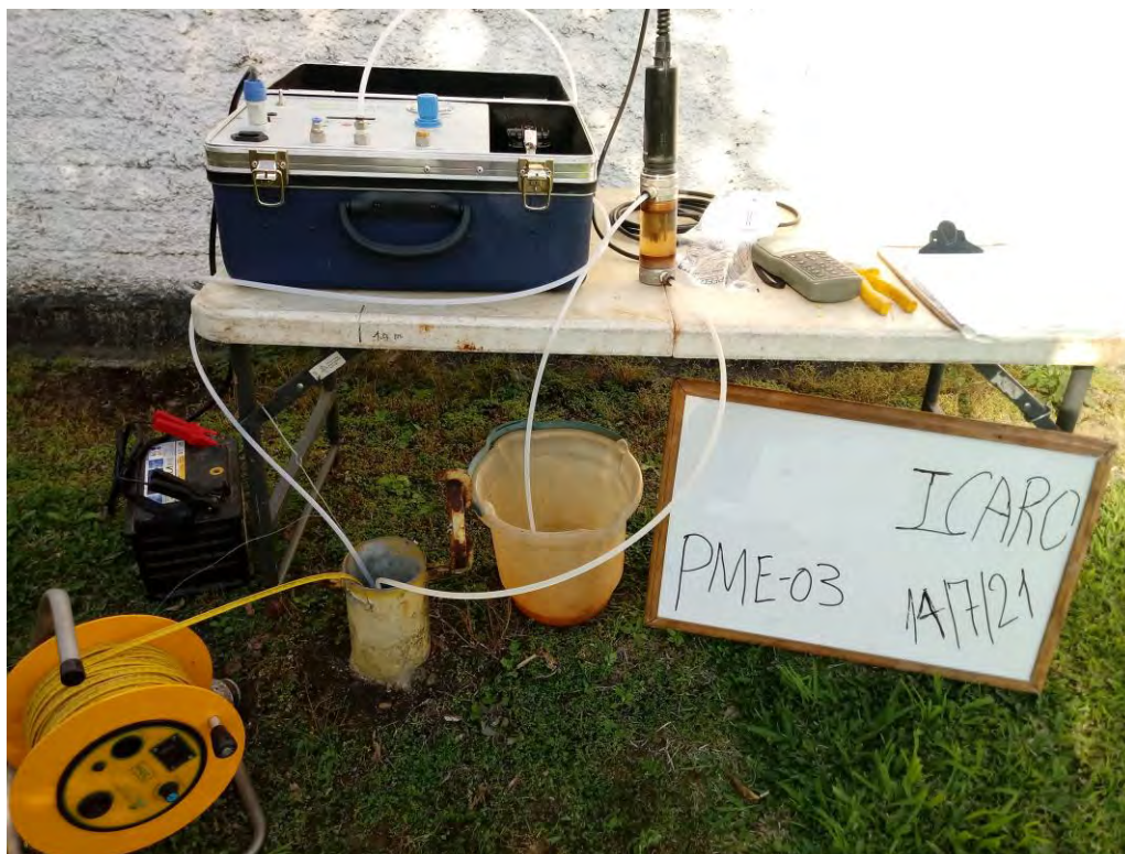
Foto 10. Amostragem através do método de baixa vazão no poço de monitoramento PME-03.
