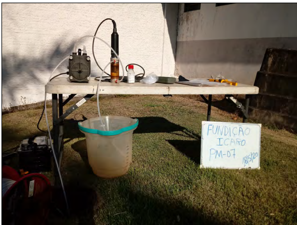
Foto 3. Amostragem através do método de baixa vazão no poço de monitoramento PM-07.
