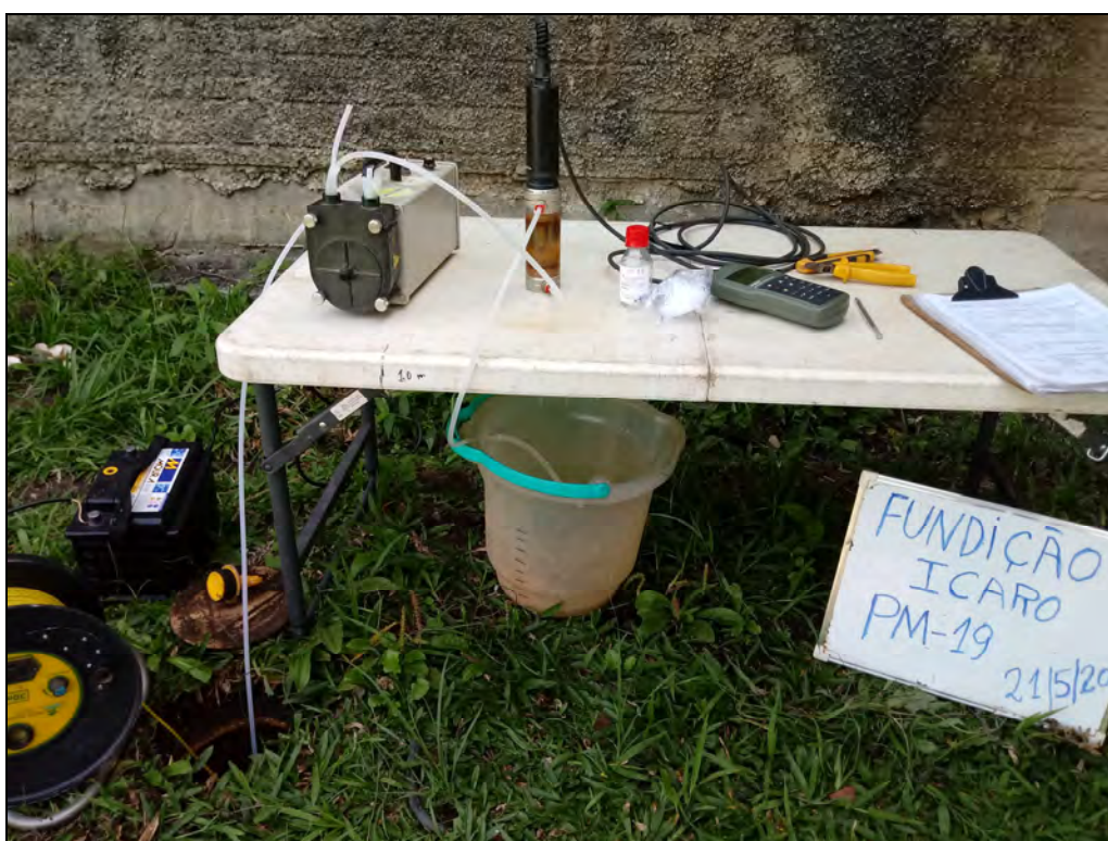
Foto 8. Amostragem através do método de baixa vazão no poço de monitoramento PM-19.
