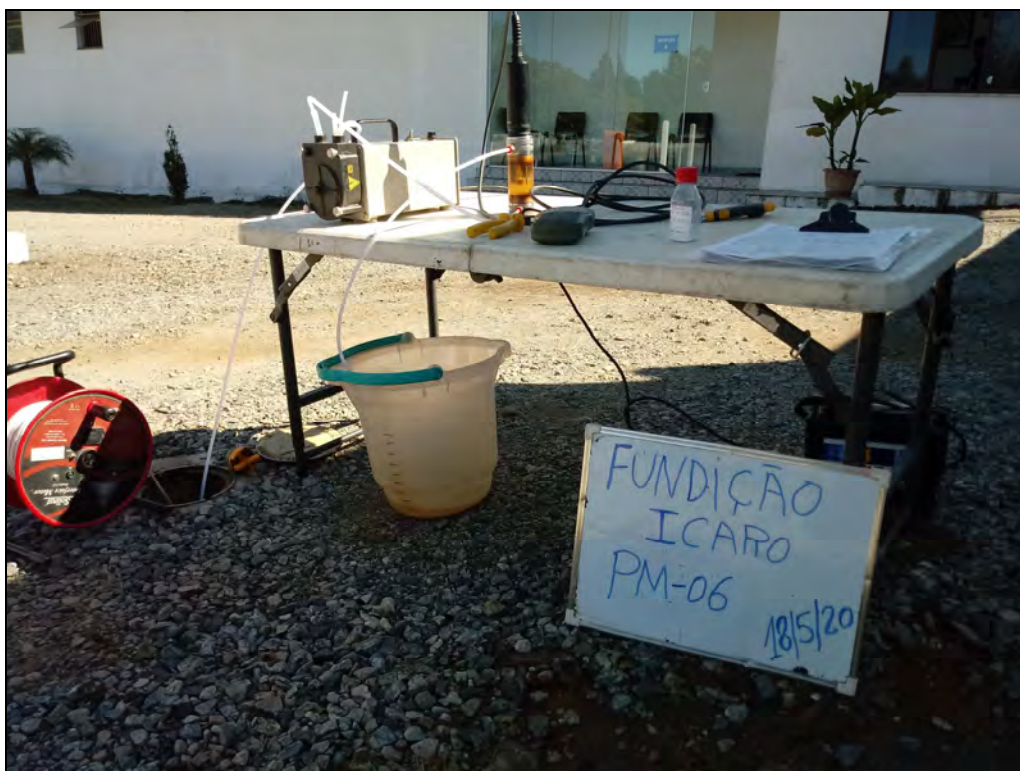
Foto 2. Amostragem através do método de baixa vazão no poço de monitoramento PM-06.
