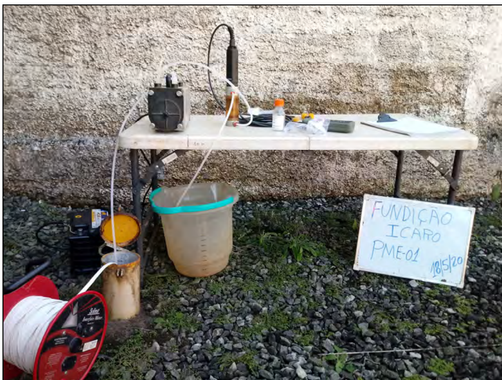
Foto 9. Amostragem através do método de baixa vazão no poço de monitoramento PME-01.
